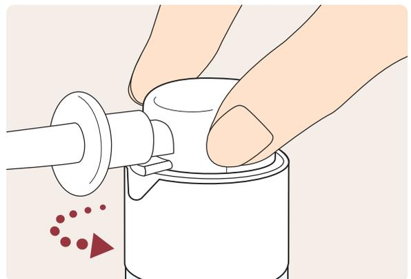
ヘッドを反時計回りにカチッと音が鳴るまで回します(ノズルが噴射ON切れ込みの真上になります)。
